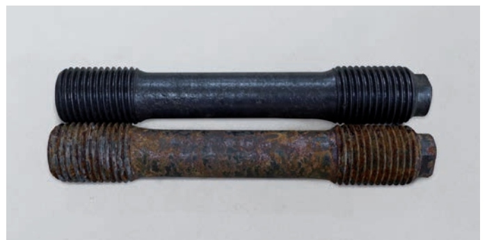
Schraube vor und nach der Reinigung
